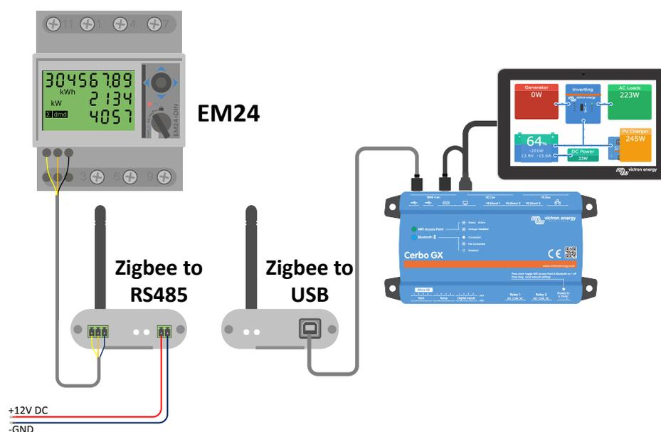
*Drahtlose Zigbee-Verbindung des Energiezählers mit einem Cerbo GX*
