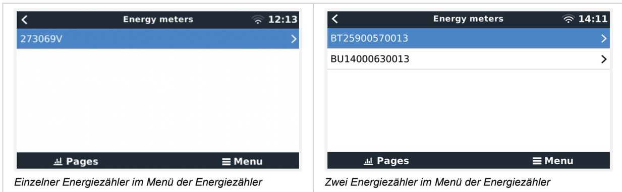
Nach der Auswahl eines Energiezählers müssen Sie die Funktion und den Phasentyp festlegen. Betätigen Sie die Leertaste oder klicken Sie mit der rechten Maustaste, um das Menü Phasentyp und Funktion aufzurufen:
